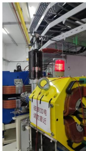
图 5-31 直线-BRing 阻挡器实体图
