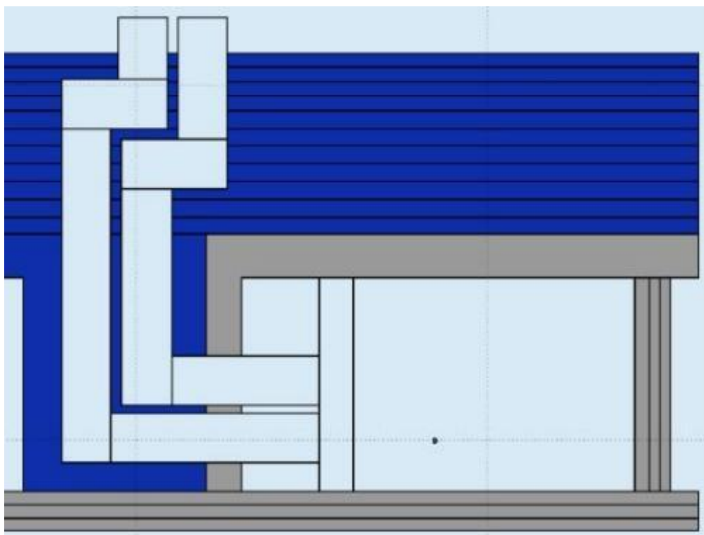
图 5-23 空调管道剖面建造图
