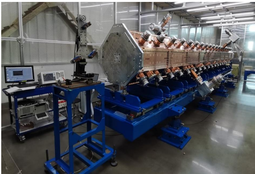
图 2.3 超导直线加速器 RFQ 装配及冷测现场
