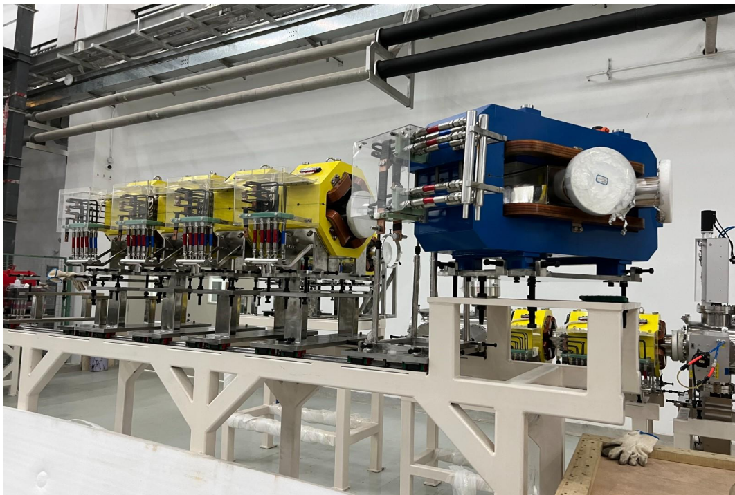
图 2.1 束流前端设备分段试装配
