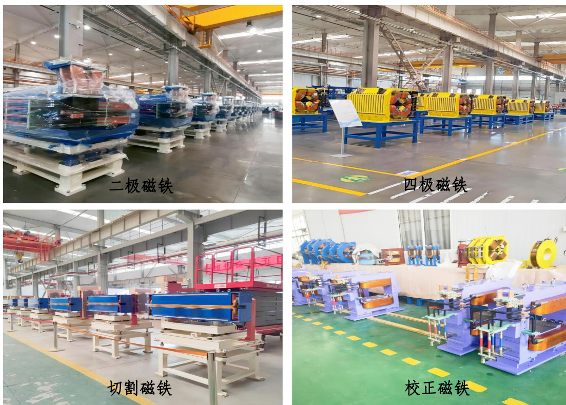
图 2.5 BRing 磁铁系统批量加工
