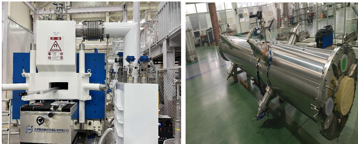
图 2.10 HFRS 温铁超导二极磁体（左）和超导 DCT 多极组合低温恒温器（右）
