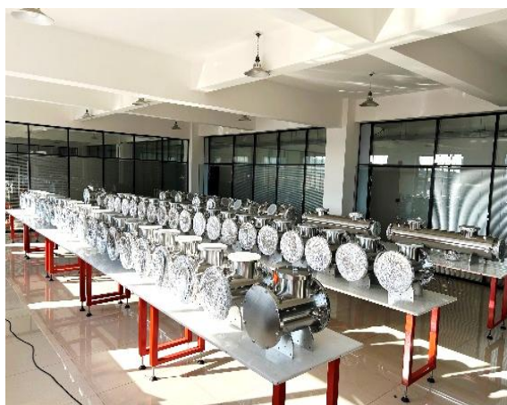
图 2.7 BRing 钛合金内衬薄壁二极铁真空室（左）和非拦截式束诊探针（右）批量加工 高精度环形谱仪 SRing 全面开展设备的批量加工与测试。磁铁系统完成不同类型首台测试，指标满足要求；电子冷却 70%设备及电子靶 40%设备完成加工与验收。2024 年 3 月陆续完成设备测试并开始进场安装，2024 年 9 月底完成 SRing 安装闭环。
