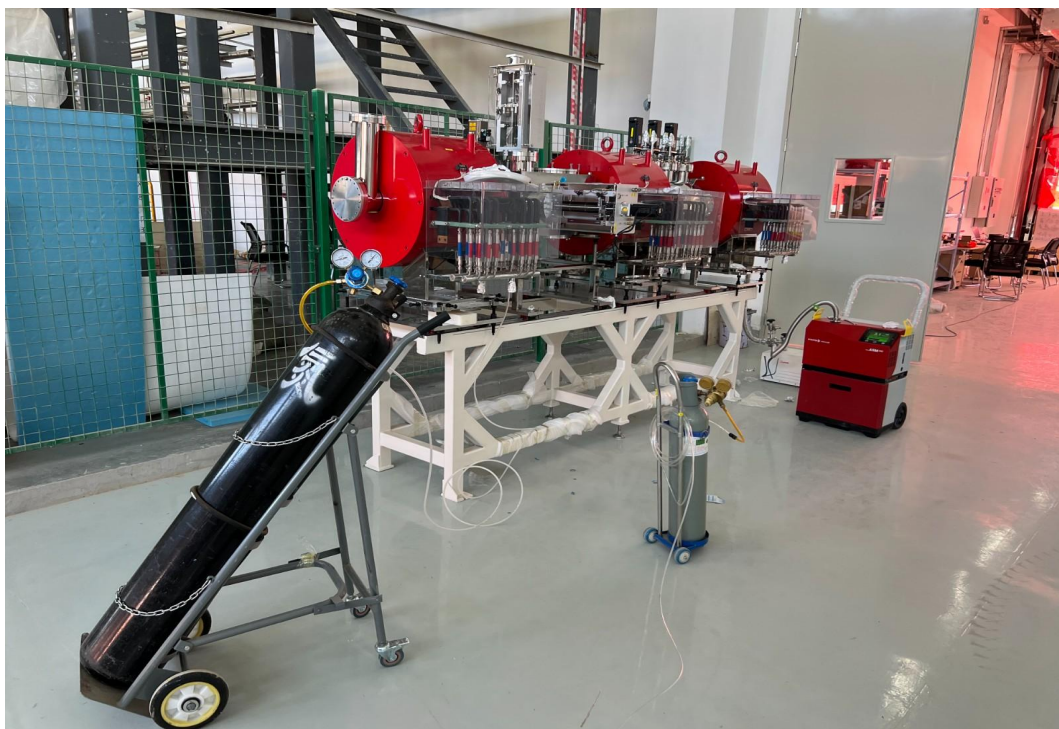
图 2.2 束流前端设备真空检漏
