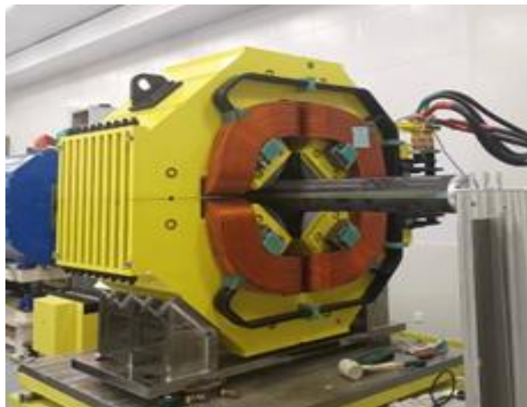
图 2.8 SRing 二极磁铁离散性测试（左）和四极磁铁均匀性测试（右）
