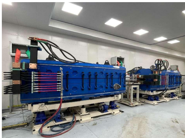
图 2.8 SRing 二极磁铁离散性测试（左）和四极磁铁均匀性测试（右）
