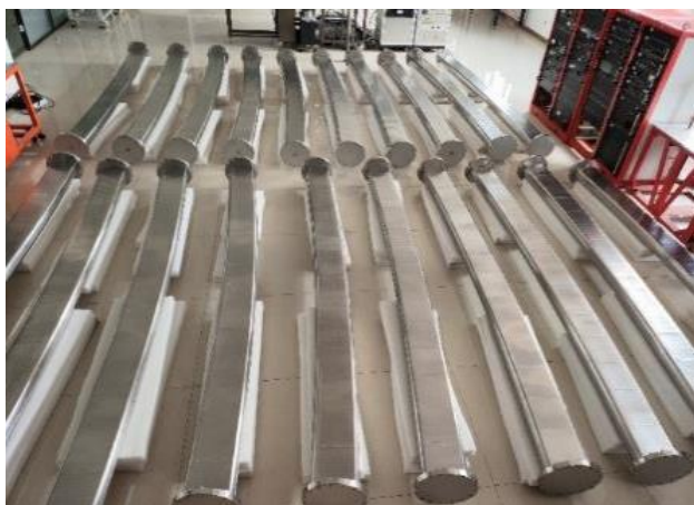
图 2.7 BRing 钛合金内衬薄壁二极铁真空室（左）和非拦截式束诊探针（右）批量加工 高精度环形谱仪 SRing 全面开展设备的批量加工与测试。磁铁系统完成不同类型首台测试，指标满足要求；电子冷却 70%设备及电子靶 40%设备完成加工与验收。2024 年 3 月陆续完成设备测试并开始进场安装，2024 年 9 月底完成 SRing 安装闭环。
