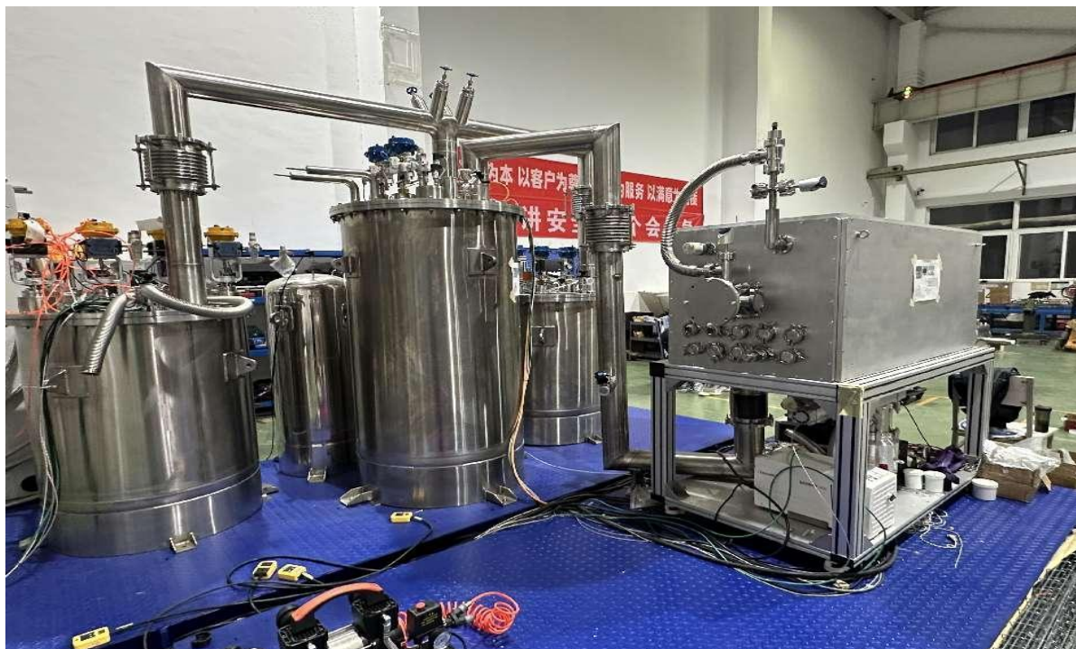
图 2.11 丰中子超重核谱仪气体单元与射频四极冷却聚束器样机
