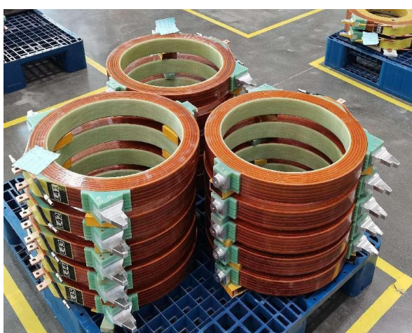
图 2.9 SRing 荧光靶离线测试（左）和电子冷却螺线管批量加工（右）
