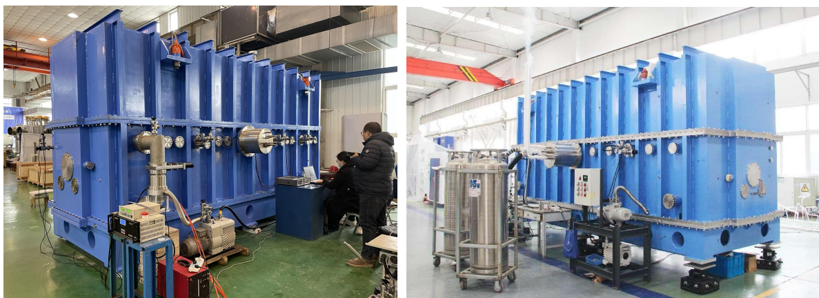
图 2.4 超导直线加速器 QWR007（左）和 HWR015（右）低温恒温器首台
