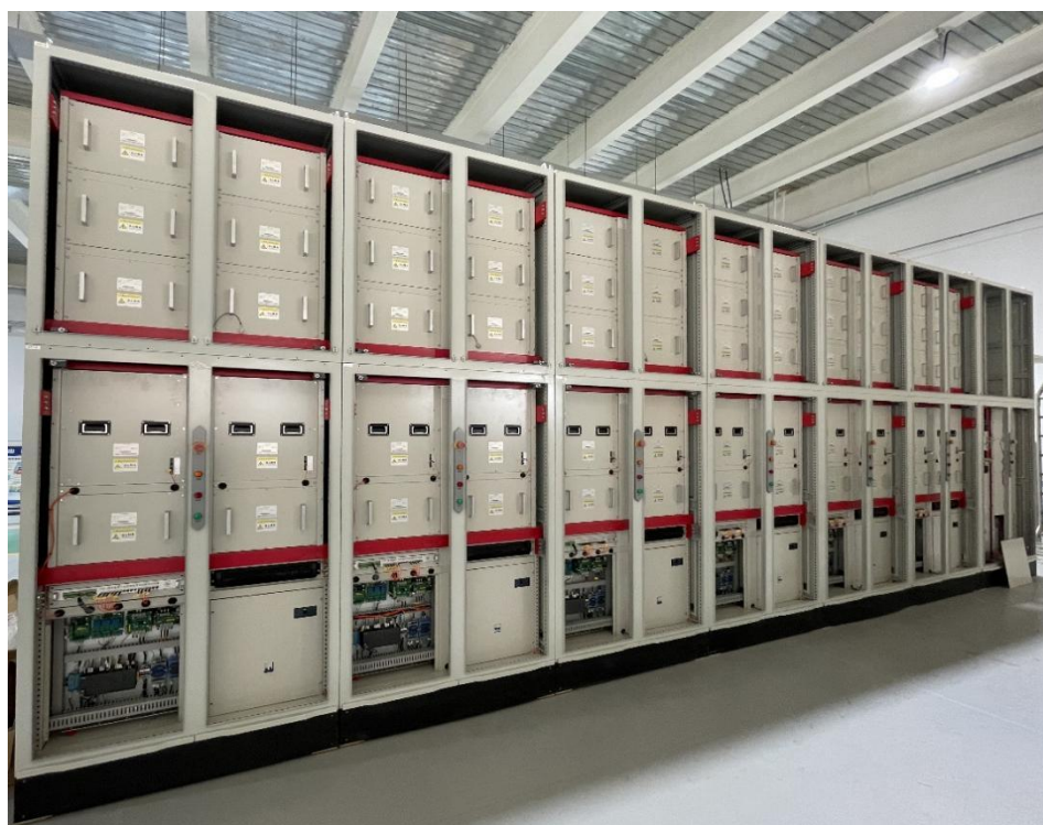
图 2.4 全储能快循环脉冲电源批量首台组装
