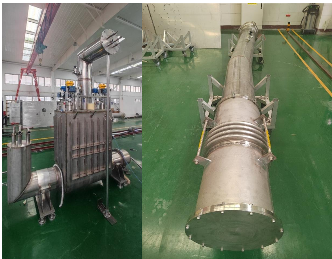
图 2.23 HIAF-HFRS 超导样段阀箱（左）与复合管路（右）
