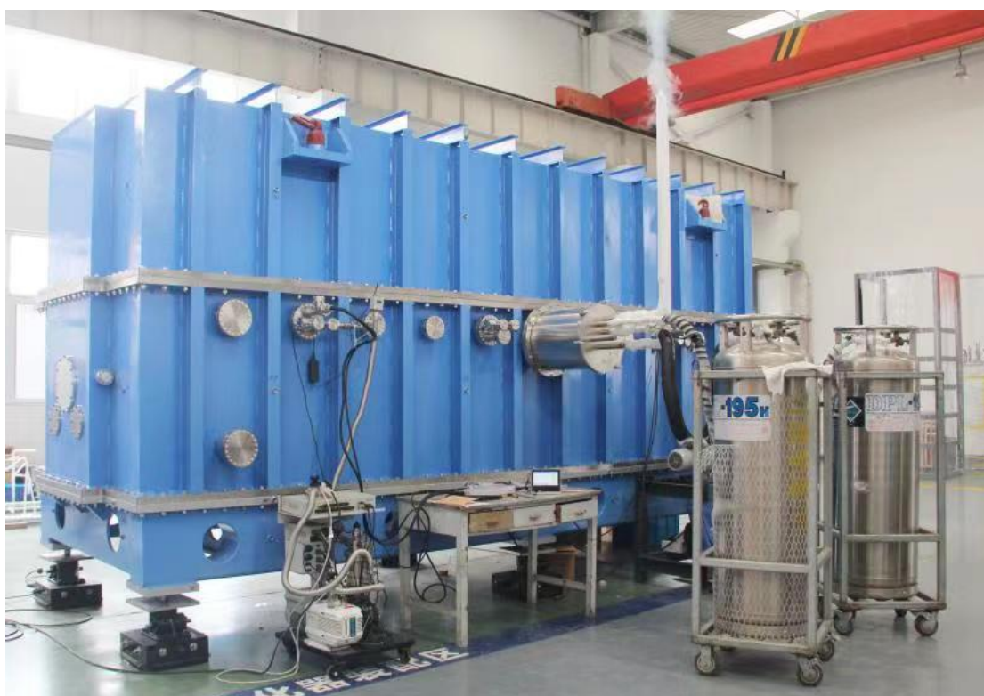
图 2.11 HIAF-iLinac 低温恒温器批量首台组装与测试
