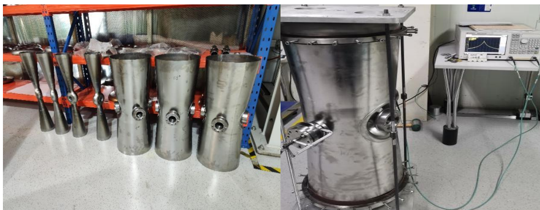
图 2.10 HIAF-iLinac 超导腔批量加工与测试
