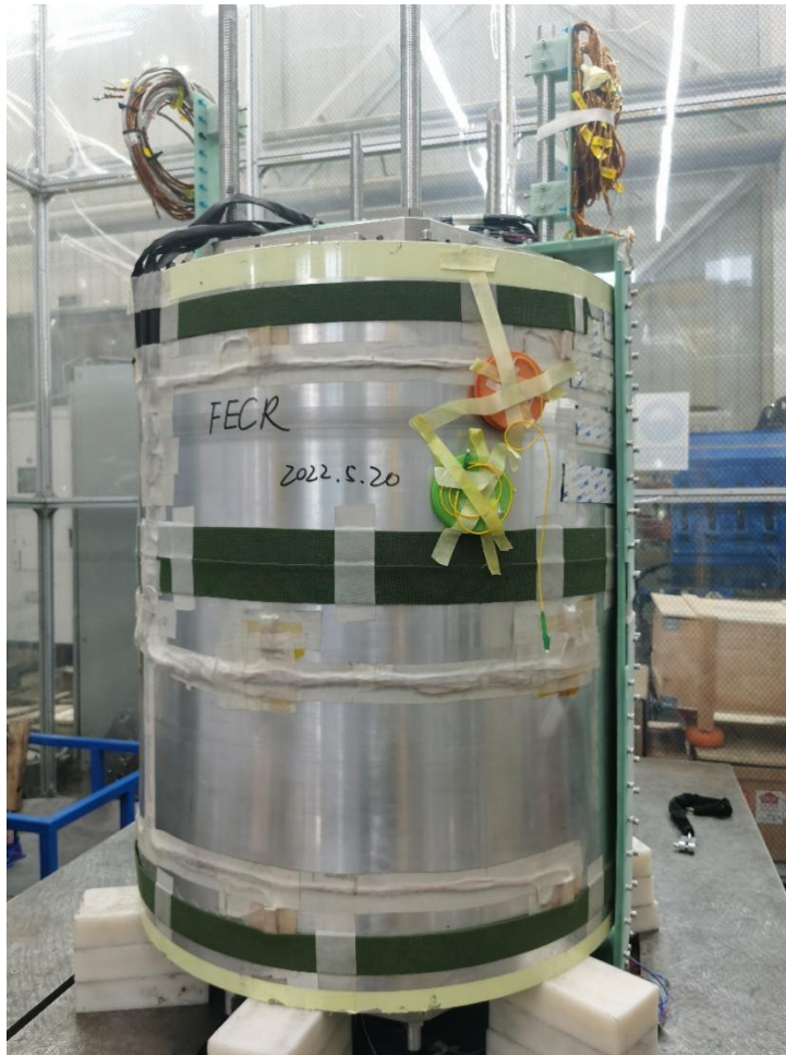
图 2.1 全 \text{Nb}_3\text{Sn} 超导离子源冷体全尺寸真机
