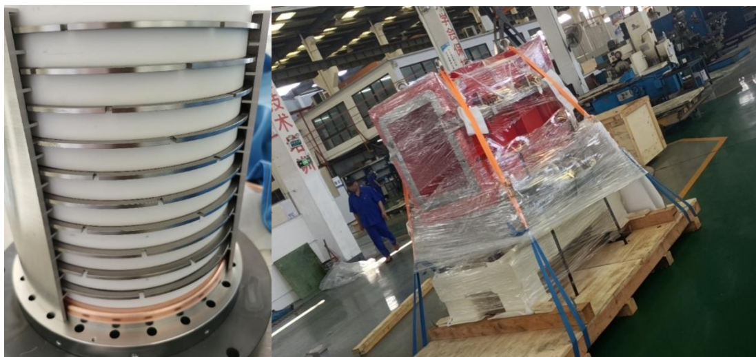
图 2.15 HIAF-SRing 电子冷却加速管（左）与冷却段磁轭（右）
