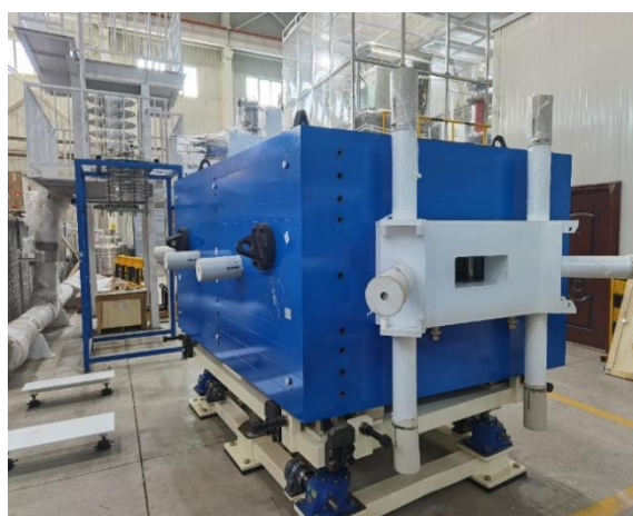
图 2.13 HIAF-BRing 四极磁铁（左）及六极磁铁（右）批量加工
