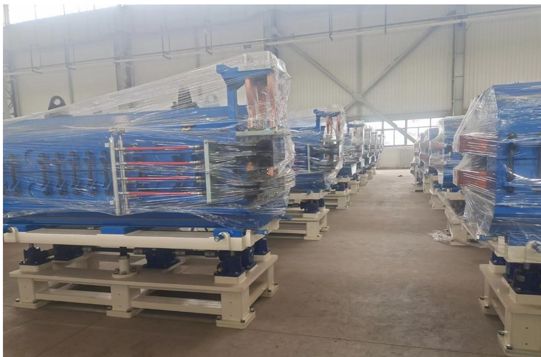
图 2.12 HIAF-BRing 二极磁铁批量加工
