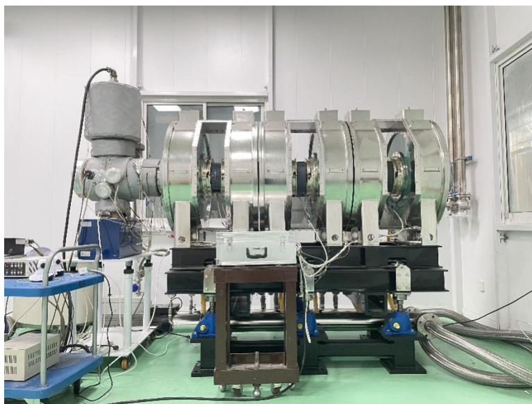
图 2.3 磁合金加载高频腔样机联合测试（真空度 5.5 \times 10^{-12} mbar）
