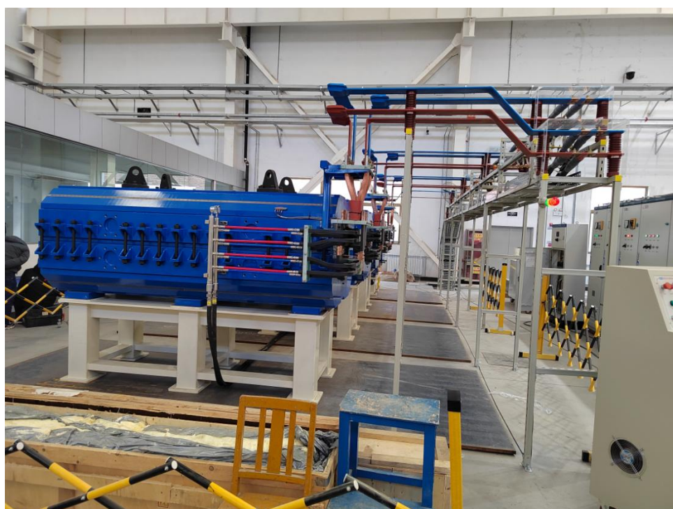
图 2.7 二极磁铁、电源、真空室及束诊样机联合测试
