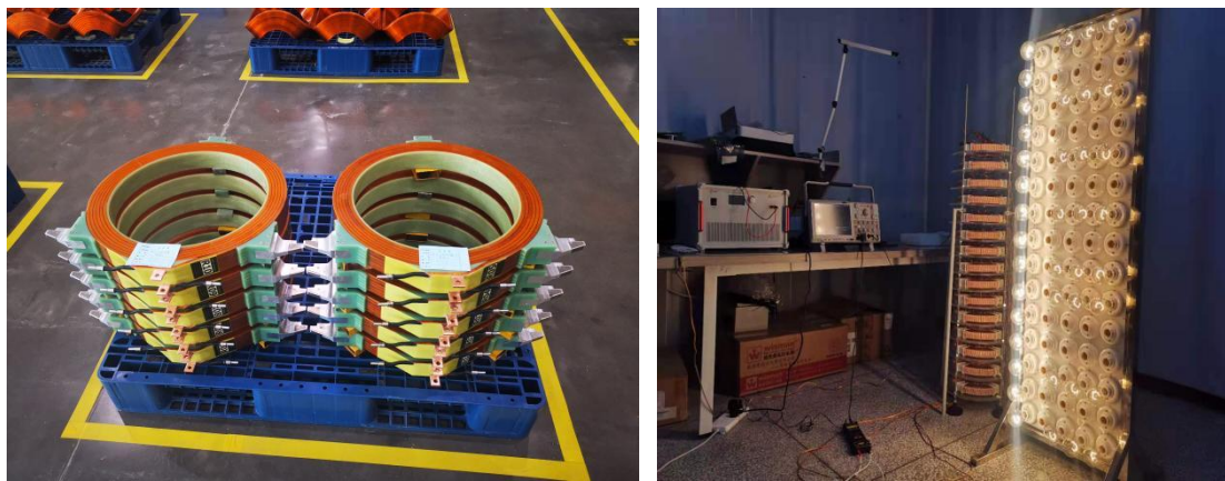
图 2.20 电子冷却高精度螺线管线圈（左）及 15 级隔离变压器测试（右）
