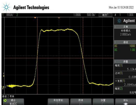
图 2.15 BRing kicker 电源及其负载电流波形（上升时间 < 400\text{ns} ，平顶度 \pm 2\% ）
