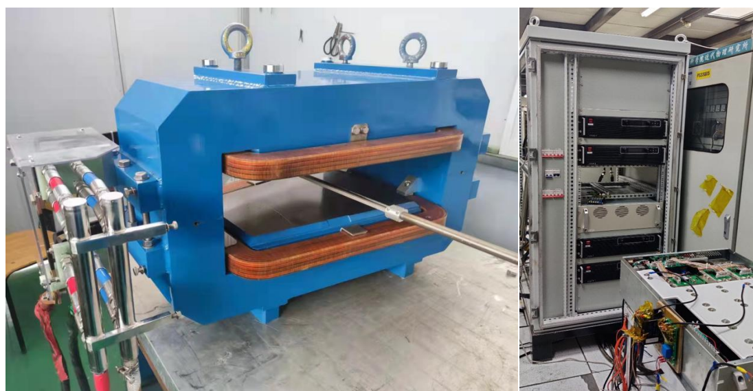
图 2.12 前端系统 45 度快切束磁铁（左）及电源（右）
