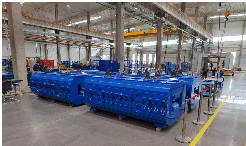
图 2.6 BRing 快脉冲二极磁铁批量加工情况
