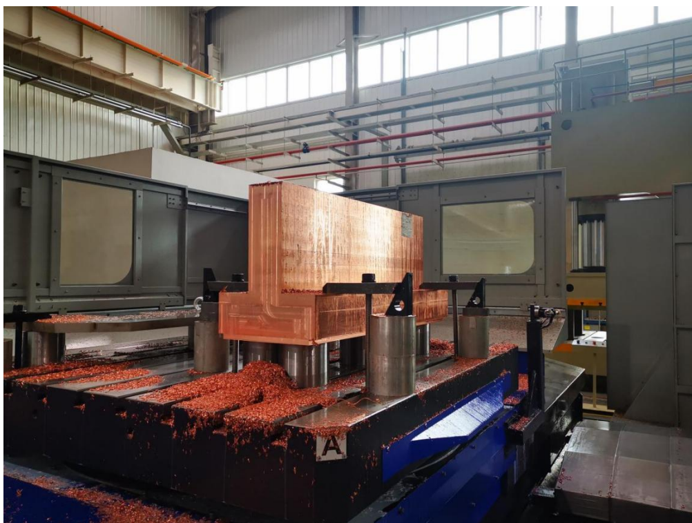
图 2.13 超导直线加速器 RFQ 粗加工
