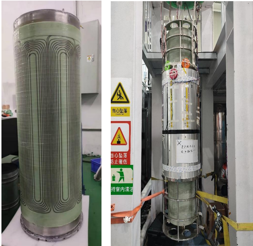
图 2.10 HFRS L800mm 全孔径多极组合样机及其低温测试组件安装
