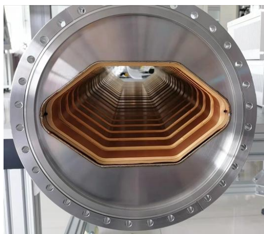
图 2.17 BRing 八边形陶瓷内衬薄壁四极铁真空室
