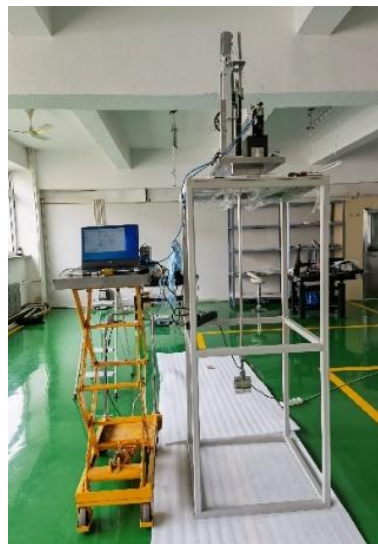
图 2.24 HFRS 抗辐射荧光靶样机
