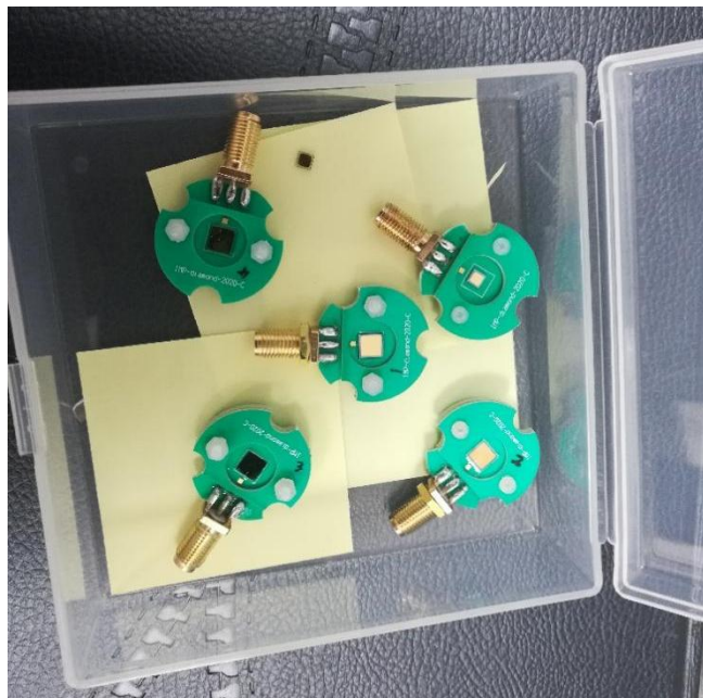
图 2.22 金刚石飞行时间探测器样机
