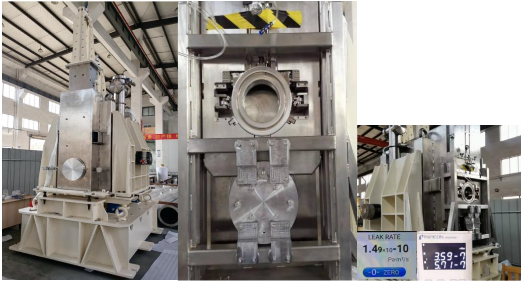
图 2.23 HFRS 初级靶室（左）与充气膨胀法兰（中）样机联合测试
