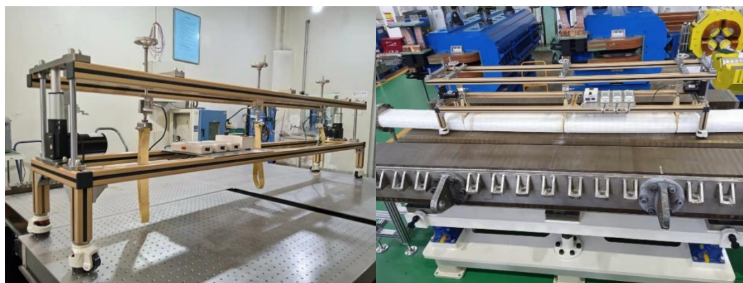
图 2.9 陶瓷内衬超薄壁真空室可升降烘烤支架与二极管磁铁烘烤联合测试
