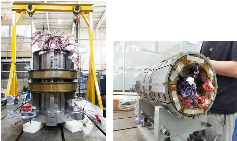
图 2.1 全 Nb 3 Sn 超导离子源冷体全尺寸真机线圈
