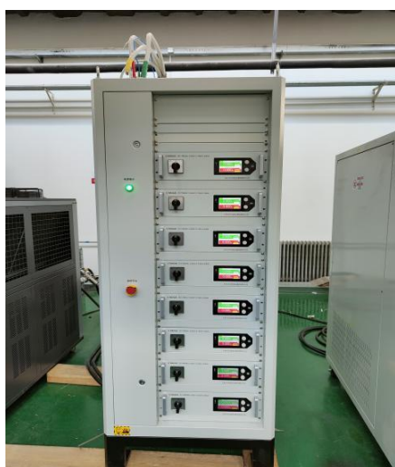
图 2.16 HFRS 抗辐射二极磁铁电源及其测试结果（1450A/145V）
