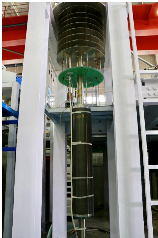
图 2.8 HFRS 半孔径 CCT 四六极超导组合磁体样机低温测试现场
